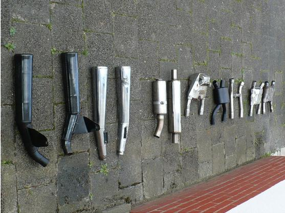
Dann umgesetzt auf 2 Endschalldämpfer. Serie R80, Kaihan und Kaihan Free Flow. Mit MSD oder mit H Rohr. Alle Lösungen an dieser Stelle kranken an der zu geringen Bodenfreiheit bei Rechtskurven.
