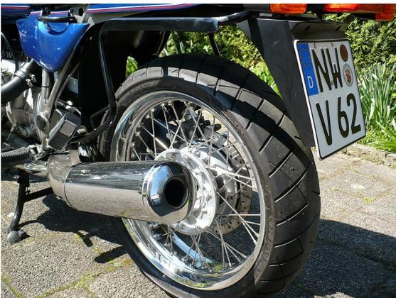
Der MSD wurde durch verschiedene Y Röhre ersetzt, der Enddämpfer Serie oder Absorptionsdämpfer Marke Eigenbau. Immer kein befriedigendes Ergebnis erreicht.
