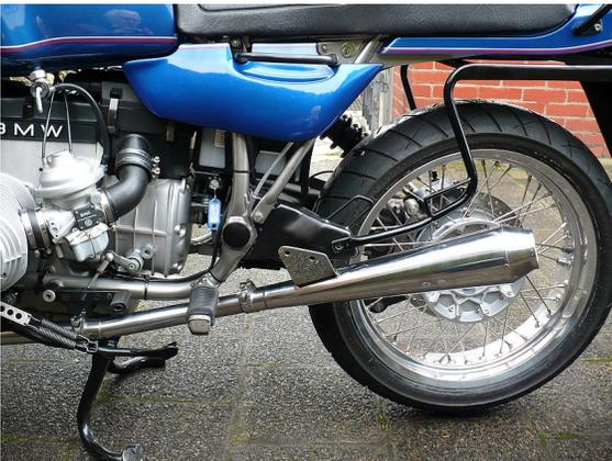
Dazu müßte der Fußbremszylinder senkrecht gestellt werden um das Manko zu beheben. Dann tritt die Beifahrerin immer gegen den Bremszylinder. War auch keine Lösung. Durch Zufall fand ich eine Sebring Auspuffanlage für die R100GS. Paßt wie angegossen, Leistungsmäßig auf der Höhe und der Klang ist akzeptabel.
