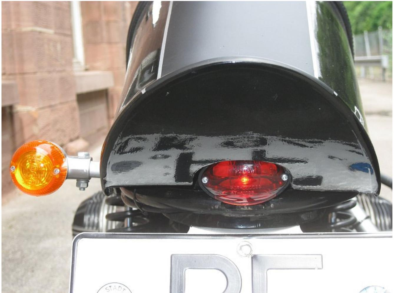
Da ich den originalen hinteren Kotflügel ausgebaut und durch einen schmalen ersetzt hatte brauchte ich natürlich auch einen Kennzeichenhalter. [Hofe](#) fertigte mir schließlich einen ganz Individuellen aus Edelstahl.
